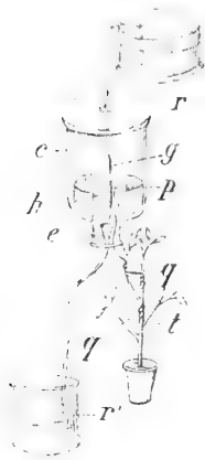
Fig. 107. — Bâton de gélatine, g ; q , p , tige de Cuscute; l , plante nourricière; c , cloche de verre; r , réservoir contenant de l'eau qui s'écoule par un siphon et tombe sur la gélatine g ; e , entonnoir où l'eau est recueillie et s'écoule dans le récipient inférieur r' (d'après M. Peirce).
